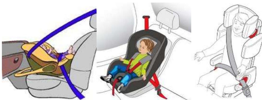
Рисунок 4. Крепление штатными ремнями безопасности
